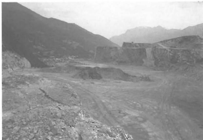
Steinbruch im Rheintal. Abbau unter Beibehaltung eines Sichtschutzes (rechts) zum Tal hin. Die Sichtschutzkulisse wird jeweils als letzter Teil der Sohle abgebaut. Der links neu entstehende Berghang wird umgehend rekultiviert. *Vorteilhaft:* Steinbruch ist trotz hoher Lage über dem Tal nur von wenigen Stellen aus sichtbar. *Nachteilig:* Lage der Fahrstraßen im Bruch muß mehrfach geändert werden. Später vermutlich auch Umsetzen der Brechanlage auf tiefere Sohle notwendig.
