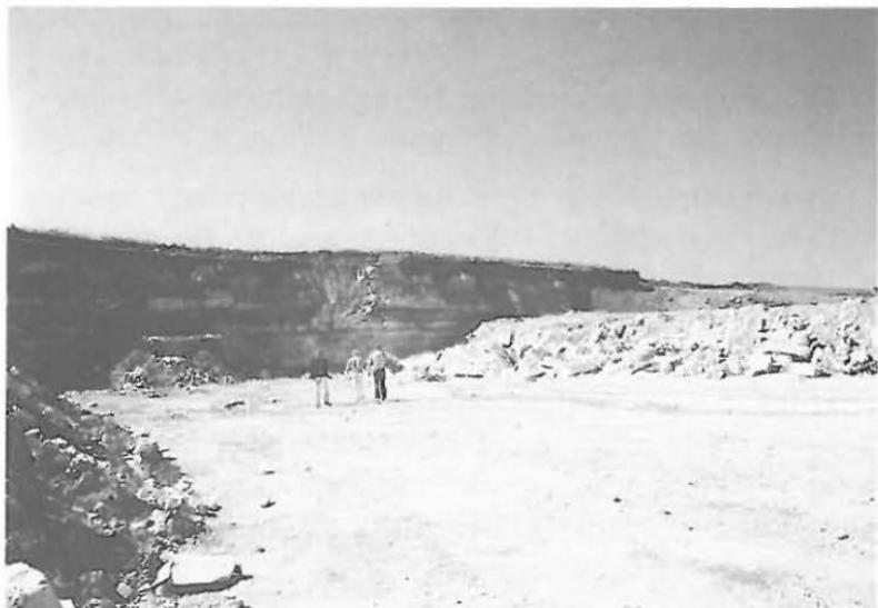
Dreisohlig geführter Gipssteinbruch in Franken. Rechts Abbau (Abbausohle, Abbaustelle 1 mit teilweise stärker verunreinigten Gipssteinen, Abbaustelle 2 mit reinen Gipssteinen), Mitte Arbeitsraum für Gewinnung und Laden, links nachrückende Verfüllung mit sofort folgender Rekultivierung. Der Abbau wandert von links nach rechts entlang der Hügelkante. *Vorteilhaft:* Kurzwegige Abraumbeseitigung, gute Trennung der Gipsqualitäten, schnelle Rekultivierung.
