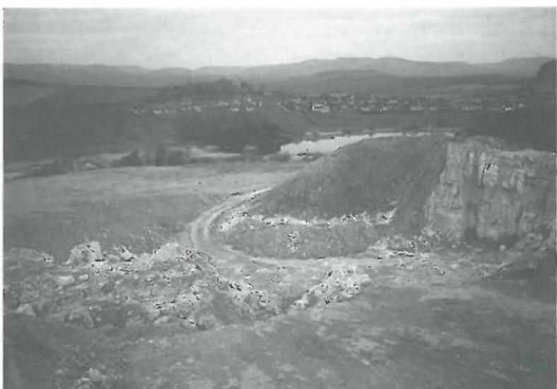
Kurzwegige Abraumbeseitigung durch Verkippen über die Abbauwand in einem Gipssteinbruch in Niedersachsen. Während an einem Teilstück der Abraum verkippt wird, geht rechts und links der Abbau daneben weiter. Anschließend, wenn die Abraumkippe in diesem Abschnitt nicht mehr benötigt wird, hinterfährt man die Kippe und gewinnt den hinter der Kippe stehengebliebenen Gipsstein herein.
